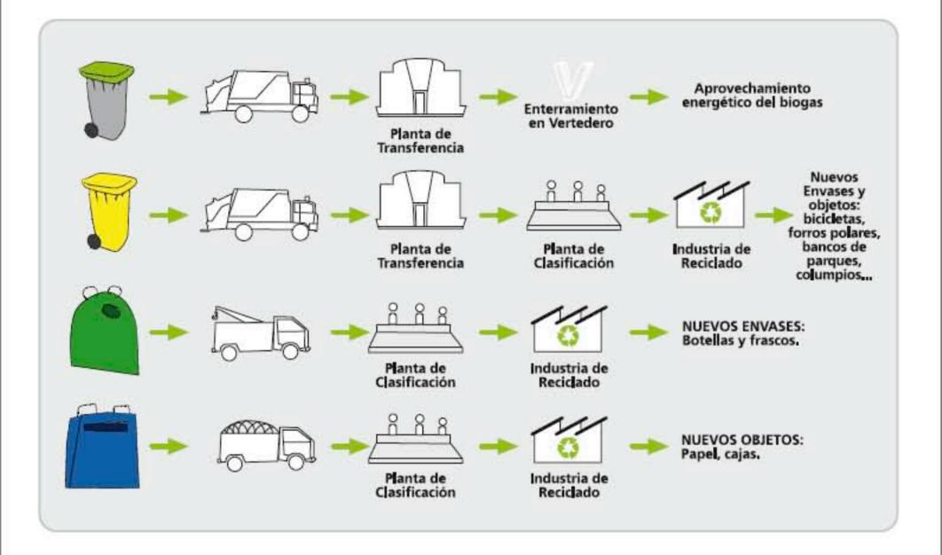
En las plantas de clasificación el trabajo mecanizado se combina con el de operarios que a través de cintas de triaje separan los materiales. El depósito incorrecto de algunos residuos supone un peligro para estas personas.
